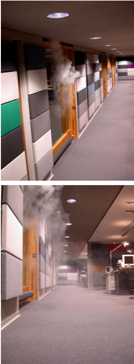
Abb. 5.6: Visualisierung des Zuluftstrahls während der Nachtlüftung
